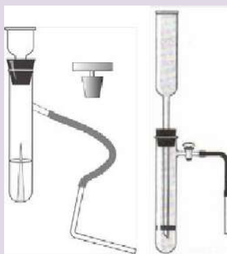
Рис. 7. Прибор для получения и собирания газов
